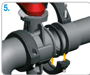
5. Colocar la segunda brida de forma que queden alineadas y apretar los tornillos alternativamente.
