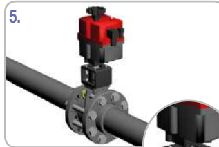
5. Montaje del actuador. Disassembly of the handle.
