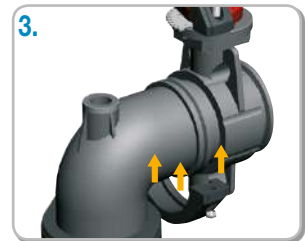
3. Colocar brida Netvitec System® inferior, encajándola en las valonas de los cuerpos.
